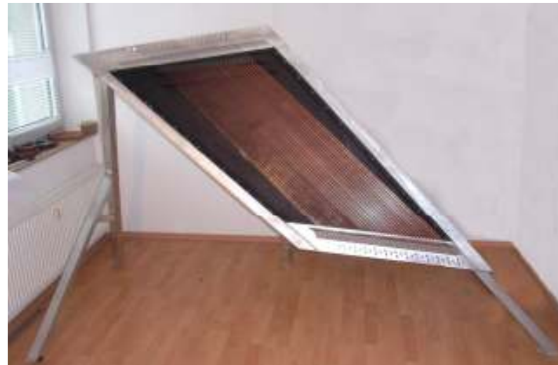
Abb. 2 , „Chordeograph 2“, Aluminiumrahmen mit 37 gespannten Saiten und Ständer, Neukonstruktion 2008 – 2009, Stand November 2008
